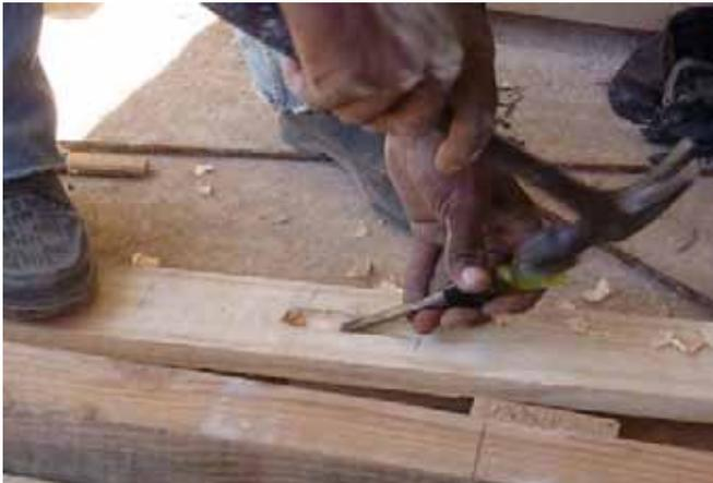
Préparation de la barre d'actionnement: percer la poignée à l'aide des ciseaux à bois.
