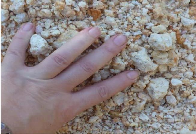
Le "sable" reçu sur le chantier est en réalité de la roche calcaire de différents calibres.
