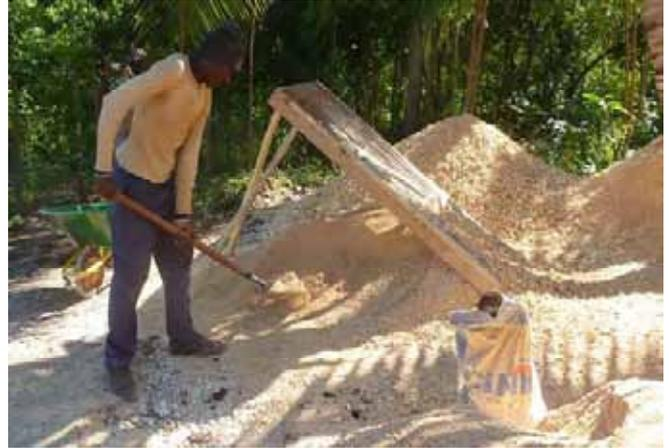
Pour la production des parpaings, le sable doit être d'abord passé au tamis.
